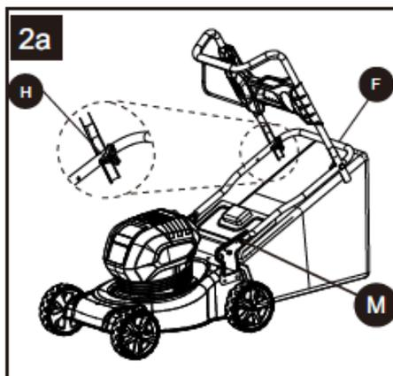
**REMARQUE: Si la poignée supérieure est desserrée ou séparée de la poignée inférieure, serrez les boutons sur les verrous de la poignée supérieure en les tournants dans le sens des aiguilles d'une montre.**
